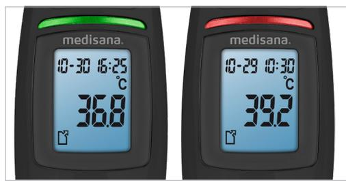
Zlarme febbre ottico tramite cambio di colore
