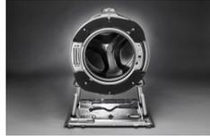
**Quattro Construction™** – Das System der Quattro™-Konstruktion ist so einzigartig wie einfach: Es besteht aus vier Stossdämpfern, die die Vibrationsenergie von der Aussenseite der Trommel in die Bodenplatte der Maschine ableiten. So geht auch Schleudern bei höchster Drehzahl nahezu vibrationsfrei.
