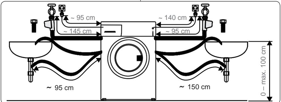
Wasserzulaufschläuche nicht eingeklemmt, geknickt, verdreht oder verbogen sind.
