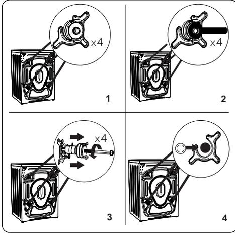
1. Entfernen Sie vor Inbetriebnahme der Waschmaschine unbedingt die 4 Transportschrauben und Gummistandhalter an der Rückseite des Gerätes. Falls die Schrauben nicht entfernt werden, können sie starke Vibrationen, Geräusche und Fehlfunktionen des Gerätes verursachen und die Garantie erlöschen lassen.
