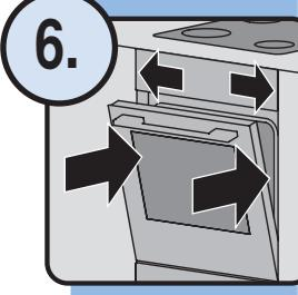
Gerät ganz einschieben, ausrichten
