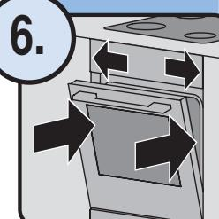
Gerät ganz einschieben, ausrichten
