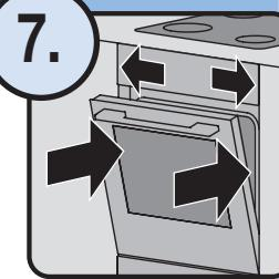
Gerät ganz einschieben, ausrichten
