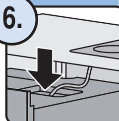
1. Erdverbindung anschliessen und zugentlasten
