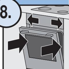
Gerät ganz einschieben, ausrichten
