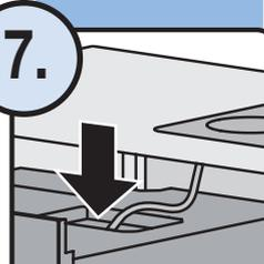
1. Erdverbindung anschliessen und zugentlasten
