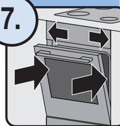
Gerät ganz einschieben, ausrichten
