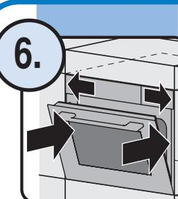
Gerät ganz einschieben, ausrichten
