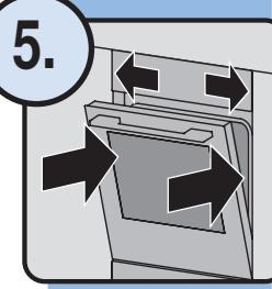
Gerät ganz einschieben, ausrichten
