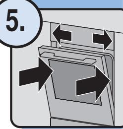
Gerät ganz einschieben, ausrichten
