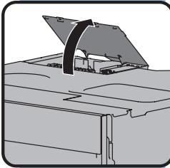
Gerät elektrisch anschliessen
