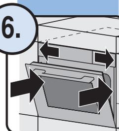
Gerät ganz einschieben, ausrichten
