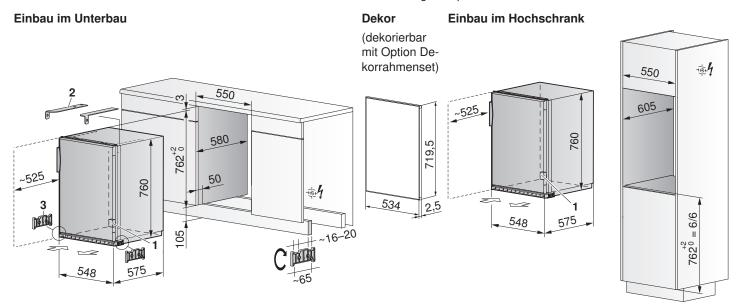
1 Lüftungsventilator, 2 Befestigungswinkel bei Steinabdeckung, 3 Einrastteil SMS-Sockel (je nach Sockeltiefe drehen). Für die Installation unter Steinabdeckung werden zwei Befestigungswinkel 2 benötigt. Bei Einbaunorm SMS sind die Befestigungswinkel links H73377 und rechts H73378 separat zu bestellen (nicht im Lieferumfang enthalten).
