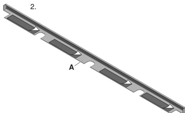
La copertura Design può essere ulteriormente fissata con 3 viti a testa svasata con calotta 3 × 12 mm.
