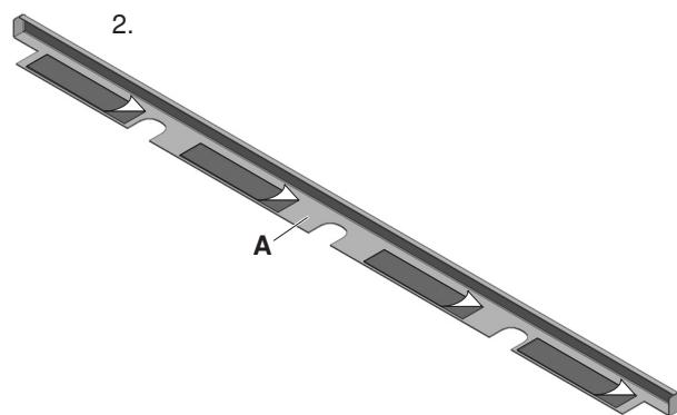
Design Abdeckung kann mit 3 Linsensenk-Spanplatten-schrauben  $3 \times 12 \text{ mm}$  zusätzlich fixiert werden.
