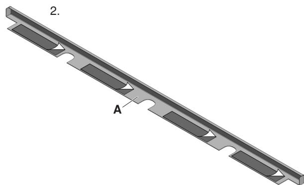
Le cache design peut être fixé en sus avec 3 vis à tête fraisée bombée pour panneaux d'aggloméré 3 × 12 mm.
