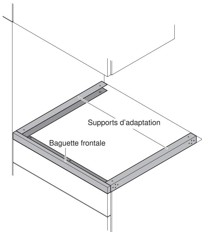
**Montaggio sotto un forno – Altezza della nicchia 635 mm**
