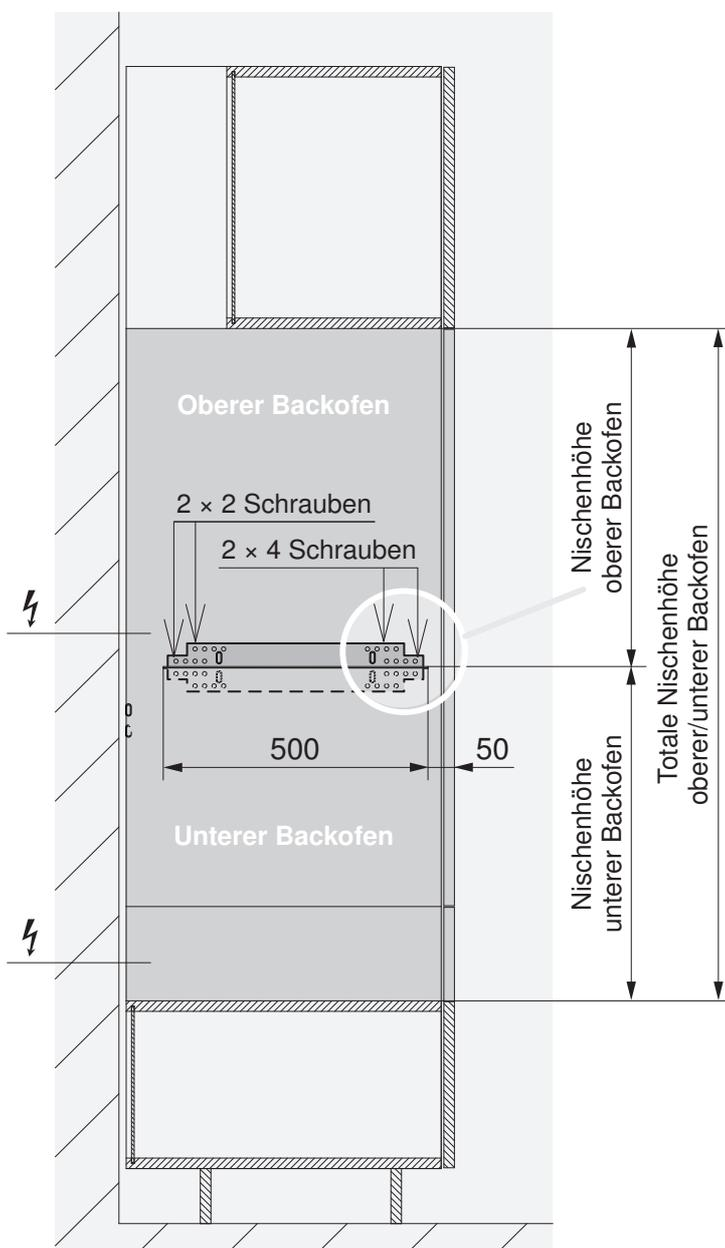
Langlöcher können zur Ausrichtung der Auflegewinkel benutzt werden. Nach dem Ausrichten müssen die Schrauben entfernt werden.
