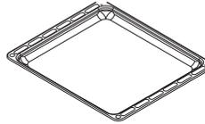
Das flache Blech wird zum Backen von Gebäck, wie Torten, verwendet. Um das Blech richtig in der Röhre anzubringen, legen Sie es auf eine Schiene und schieben es nach hinten.
